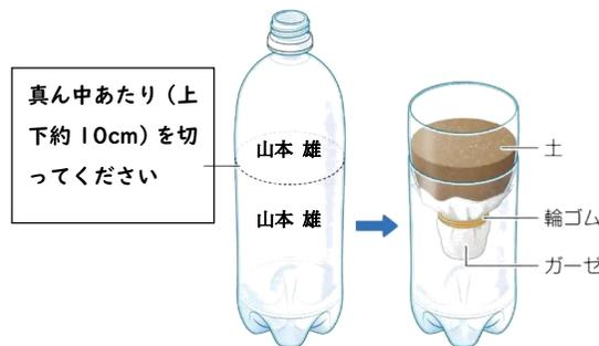
理科「流れる水のゆくえ」の実験で、ペットボトルを使ったろ過装置を作ります。つきましては、500mlのものを図のように切り、双方に記名して持たせてください。学校で逆さに連結させて作成します。断面の円いものの方が操作性がよいのでおすすめです。6/9(月)までに準備をお願いします。
